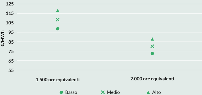
Figura 3.5: LCOE per il fotovoltaico abbinato allo storage.
